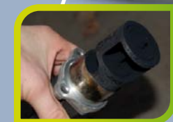
Vanne EGR calaminée
